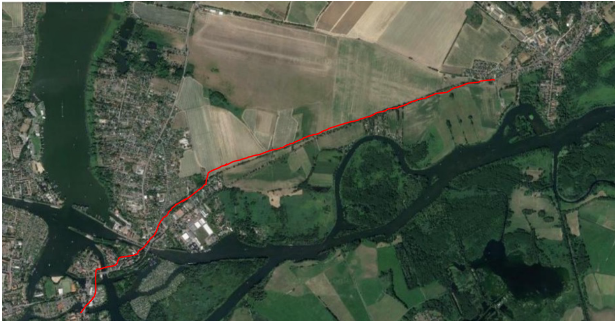
Tracé de la canalisation de refoulement
